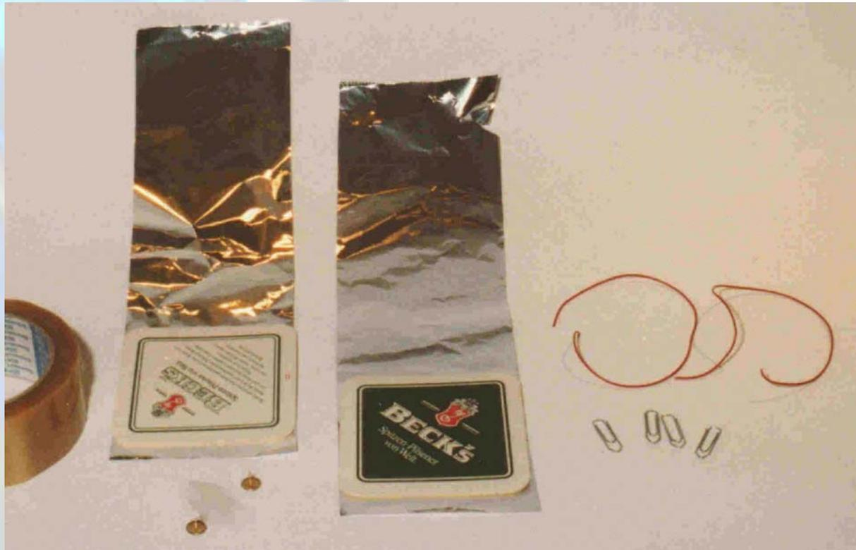
Bestandteile des Empfängerkondensators. Statt des Klebebandes wird Bucheinschlagfolie benutzt, da sonst der Abstand zwischen den Platten zu groß wird.
