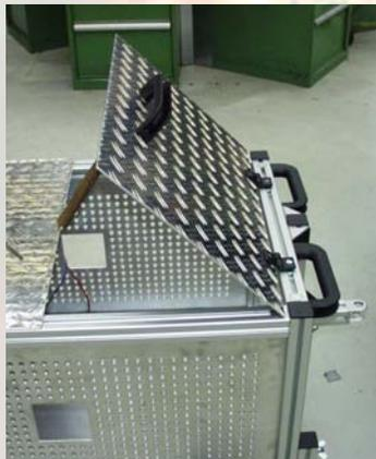
La tapa superior puede abrirse parcialmente y a su vez ocultar el interior. La parte no fija puede abrirse con la mano. En la mitad de la tapa fija pueden añadirse algunos elementos.
